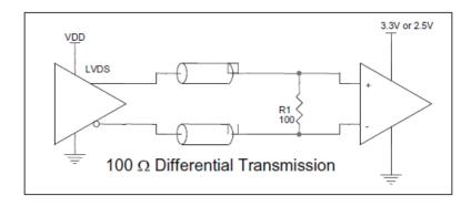
FIGURE 4. TYPICAL LVDS DRIVER TERMINATION
